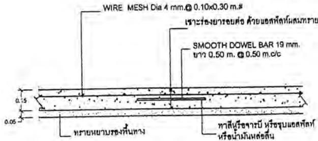
DETAIL. CONSTRUCTION JOINT (รอยต่อเพื่อก่อสร้าง)
