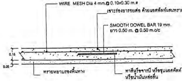
DETAIL. 1. CONSTRUCTION JOINT (รอยต่อเพื่อก่อสร้าง)
