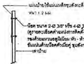
แสดงการติดตั้งป้ายไม้กับ ป้ายเตือน
